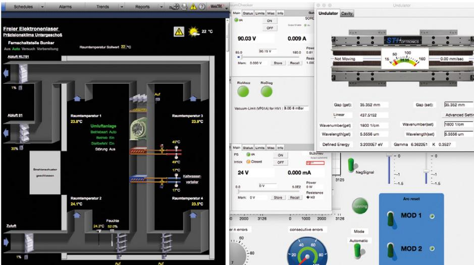
Bedienoberfläche für Freie-Elektronen-Laser mit BACnet-Integration.
